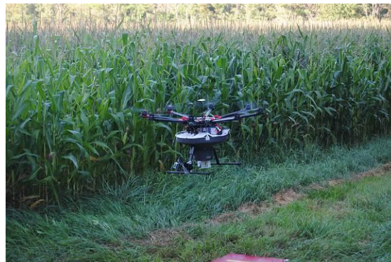
Décollage du drone multicoptère chargé de 2000 capsules de Trichotop® Max correspondant à 8 ha de traitement
